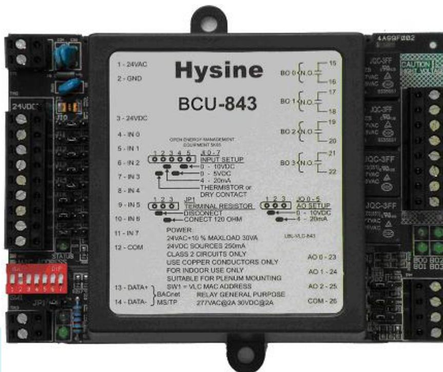
当今的楼宇自控系统推崇集散型控制结构。BACview 现场 DDC 控制器的类型十分丰富，能够满足楼宇自控系统各种设备的控制要求。BACview 的所有现场 DCC 控制器都是可编程的，因而能够脱离系统对设备进行就地控制，避免了由于系统故障导致设备无法正常运行的严重后果。BACview 现场 DDC 控制器的点数也是经过对楼宇系统的深入研究和实践后确定的，选定 DDC 控制器的基本原则是：一个 DDC 控制器控制一台设备；例如，一台空调机组可以选用一个 DDC 进行控制。这样做的优点无论从控制角度、信号布线角度、系统可靠性角度、以及经济性角度都是显而易见的。
